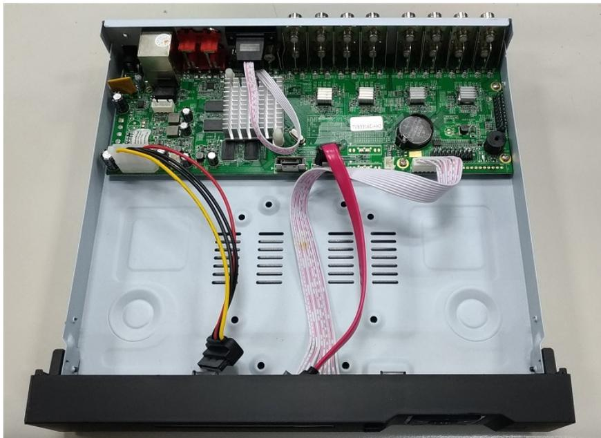
2. HDD電源ケーブルとSATAケーブルをそれぞれPCBAボードとHDDのスロットに差し込み、接続が正しく行われていることを確認します。
