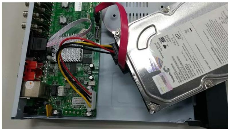
3. HDDのネジ穴をHDVRケースのネジ穴に合わせ、所定のネジで固定します。
